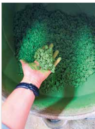
► Figura 4 Betonada de concreto verde e sua consistência
